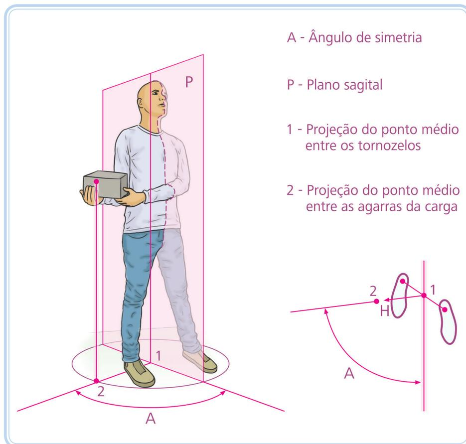
**Figura 5.5: Representação gráfica do ângulo de assimetria do levantamento (A)**
